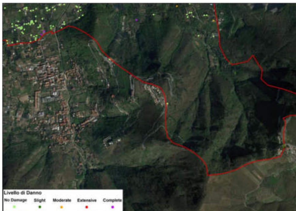
Figura 42: Mappa del livello di danneggiamento dell'edificato - Quadro di Unione 3.
